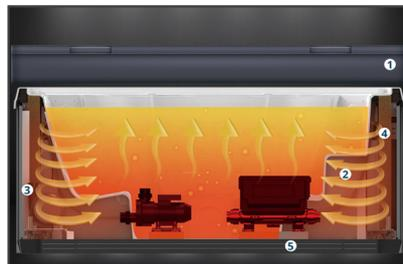
**5-stufiges „Platinum-Lock“ Vollschaum Isoliersystem** - basierend auf jahrzehntelang bewährter Kühlschrankschrank-Isolier-Technologie:
